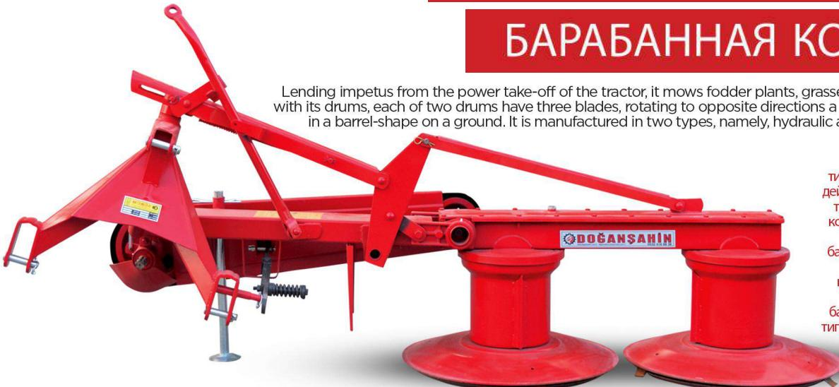
Эта косилка подвесного типа, которая приводится в действие от хвостового вала трактора и косит все виды кормовых растений, травы, сорняки с помощью барабанов, вращающихся в противоположных направлениях, и 3 ножей, имеющихся на каждом барабане. Выпускаются два типа: в виде гидравлических и механических систем.
